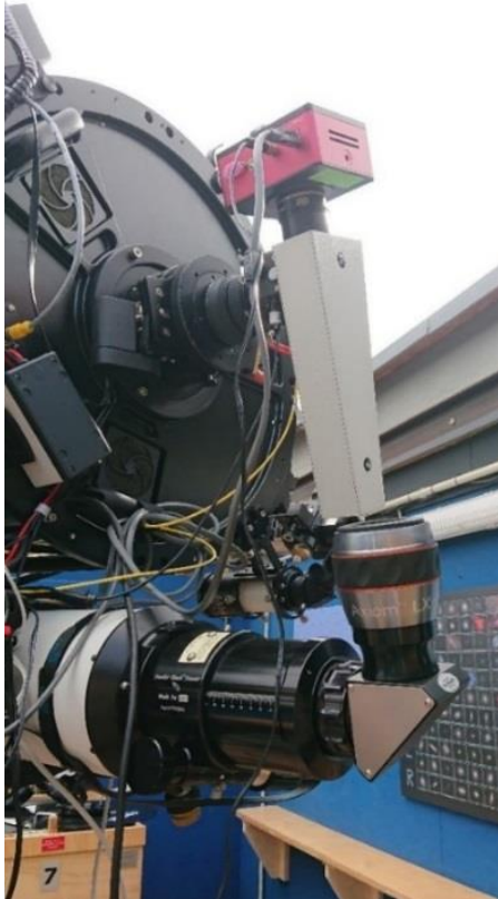
Abbildung 5: Echelle Spektrograph und CCD-Kamera (rot) angebracht am CDK 20
