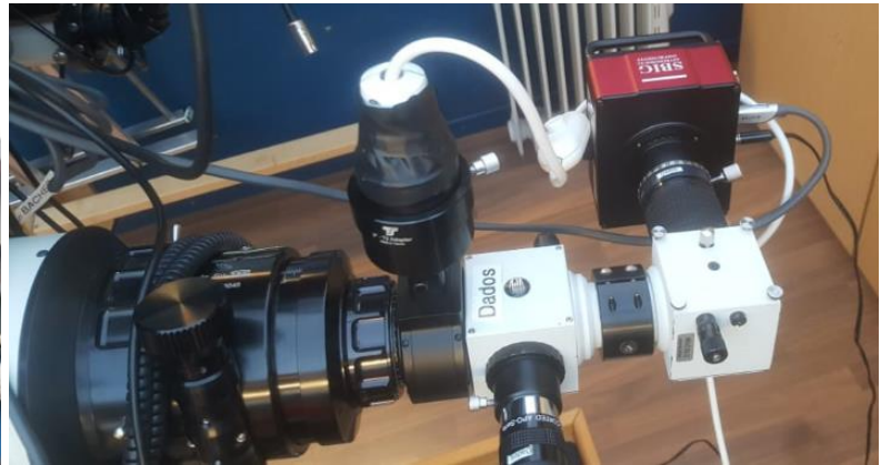
Abbildung 4: DADOS Spektrograph mit angeschlossener CCD-Kamera (rot)
